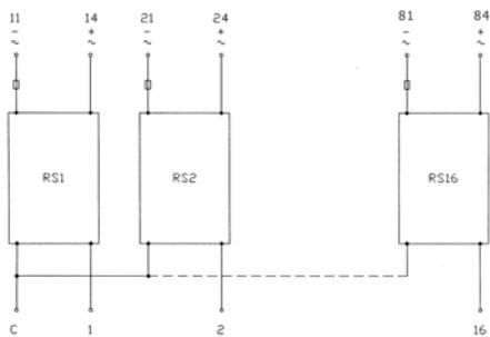
Schema di collegamento Modulo interfaccia a 1 relé statico mod. SSR91-60B5 / mod. SSR91-60B.
