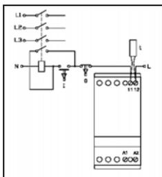
Il termostato è collegato in serie con il circuito di controllo del gruppo statico. Quando la temperatura del dissipatore supera i 90°C/100°C il gruppo statico si diseccita. Uno start manuale è necessario per eccitare nuovamente il circuito.
