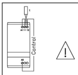
Il termostato è collegato in serie con il circuito di controllo del contattore principale. Quando la temperatura del dissipatore supera i 90°C/100°C il contattore principale si diseccita.
