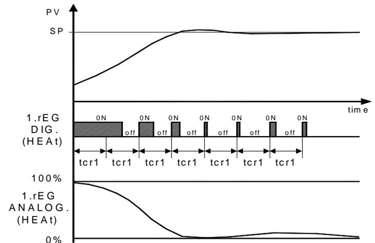
Per ottenere una buona stabilità della variabile in caso di processi veloci e di comando dell'attuatore con uscita digitale, il tempo di ciclo "tcr1" deve avere un valore basso con un intervento molto frequente dell'uscita di regolazione.
