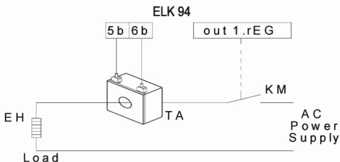
Per la configurazione dell'uscita a cui destinare l'allarme di Heater Break è necessario prima stabilire a quale uscita deve corrispondere l'allarme.
