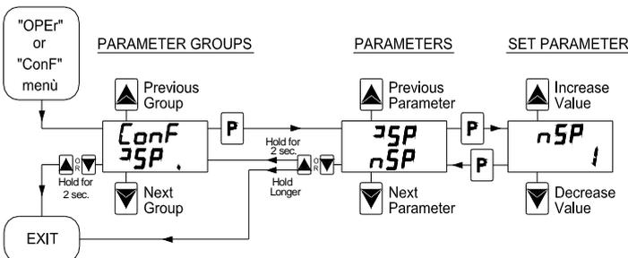
**ATTENZIONE:** Lo strumento viene programmato in fabbrica con tutti i parametri, ad eccezione del Set Point "SP1" (e 2,3,4), programmabili nel menù "ConF" allo scopo di prevenire errate programmazioni accidentali da parte di utenti non esperti.
